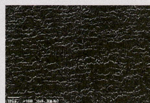
処理後 Ra0.2の摺動面にRa0.3の凹み形成
