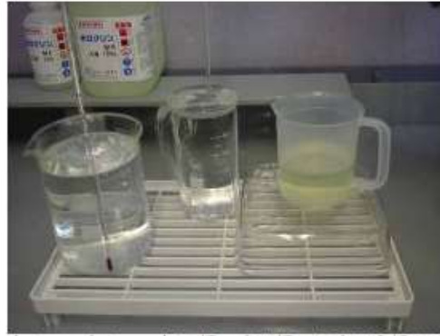
向かって右から 処理槽、水洗槽、温水洗浄槽を想定して用意しました。
